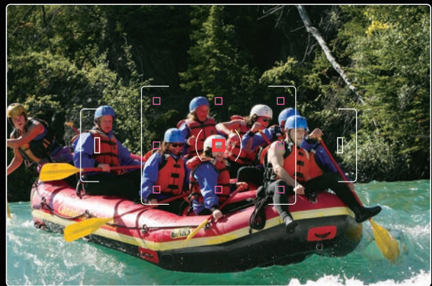
Quando è selezionato come punto AF uno dei sensori interni, il suo funzionamento è supportato dagli otto sensori vicini. I sensori coinvolti sono evidenziati in rosa sullo schermo di stato.
