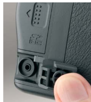
Sul fianco destro, sotto al vano per le schede di memoria SDHC, si trova l'ingresso per il comando di scatto a filo.
