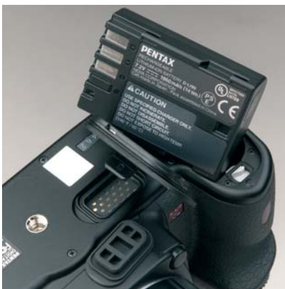
La batteria è una D-LI90 da 7,2V e 1860mAh. Sul fondello si trovano anche il connettore per il battery grip opzionale e la filettatura per il treppiede.
