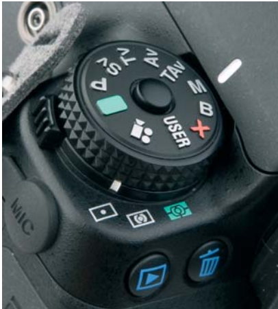
La ghiera di selezione dei programmi, coassiale a quella per la scelta del metodo di lettura esposimetrica, offre anche la priorità alla sensibilità ISO.
