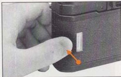
5. Azionate la leva di avanzamento pellicola, controllando che il bottone di riavvolgimento pellicola ruoti in direzione della freccia.
